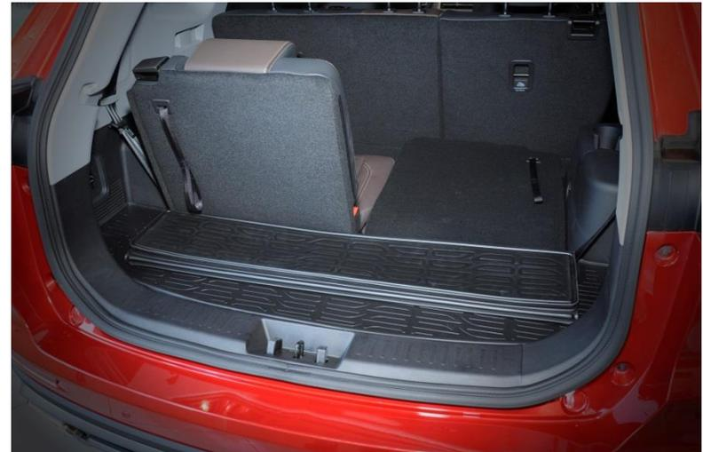
Сегменты ковра TRI-FOLD соединены между собой специальным элементом, конструкция которого позволяет сгибать сегменты ковра относительно друг друга под углом 180 градусов как в одну, так и в другую сторону.
